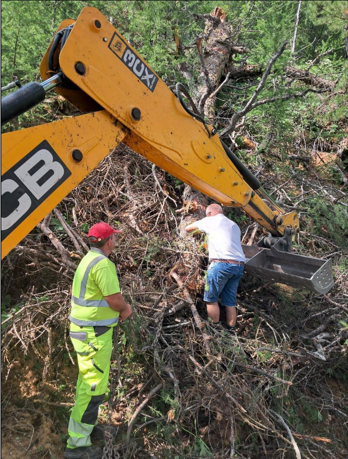
L'idée est d'attacher le tronc avec une chaîne, et de le dégager avec l'un des deux tractos.
