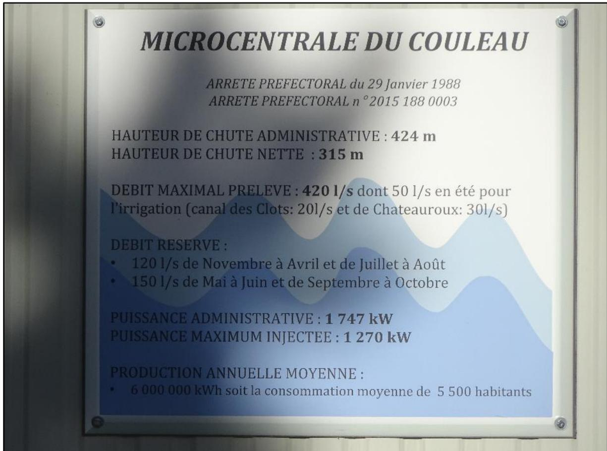
La microcentrale date de la fin des années 1980, j'ignore la différence entre les données administratives et les données réelles. Je vois que le captage sert également à l'irrigation et que si le débit de la conduite est relativement faible, c'est compensé en termes de puissance par une hauteur de chute importante. Me trouvant à peu près à 900 m d'altitude, le captage se situant à plus de 1300 m, je sais ce qu'il me reste à faire.
