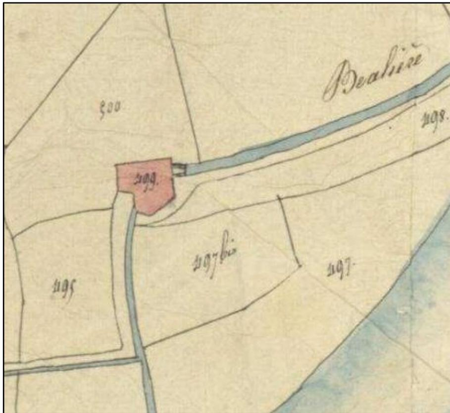
Le canal d'amenée s'appelle « Bealière du Moulin ». Celui-ci n'a pas vraiment de forme déterminée, des chemins longeant les canaux le desservent, le canal d'amenée est le plus large et se termine par deux entrées d'eau, probablement pour alimenter deux roues et deux meules.
