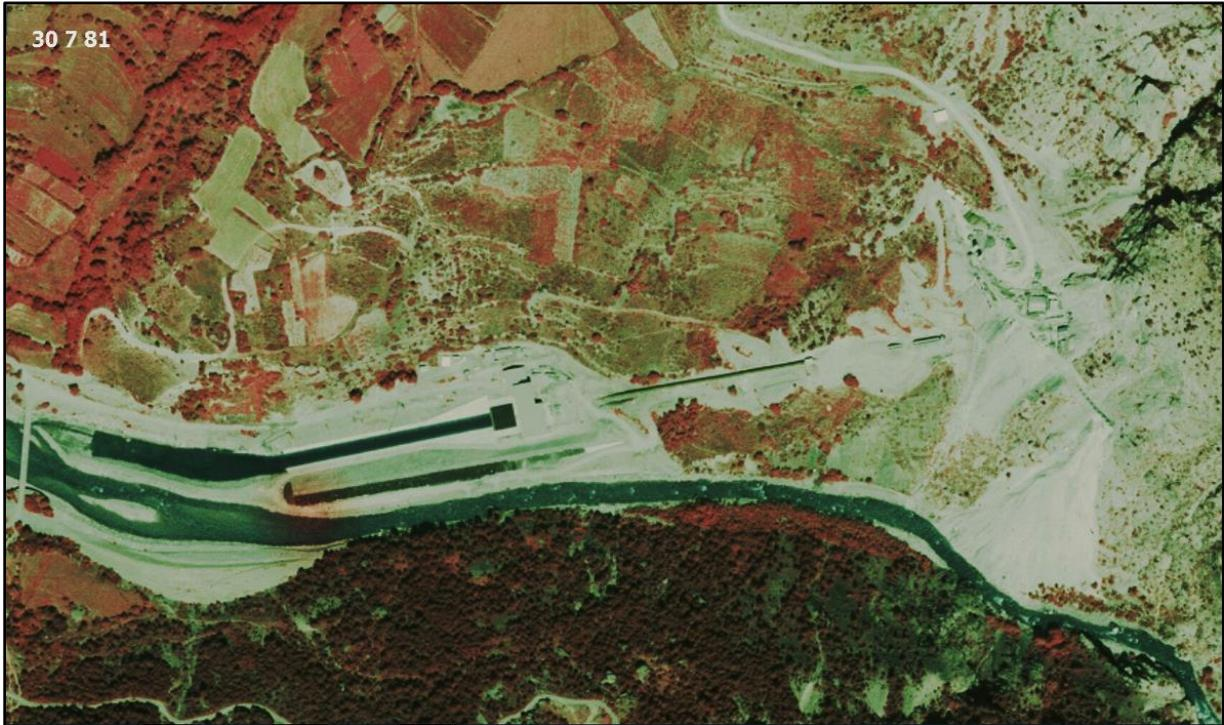
Si les bâtiments ne se discernent pas aisément, le canal de sortie saute aux yeux. Si la conduite forcée est installée, l'usine ne fonctionne pas à cette date, car il n'y a pas de réel rejet d'eau dans le torrent.
