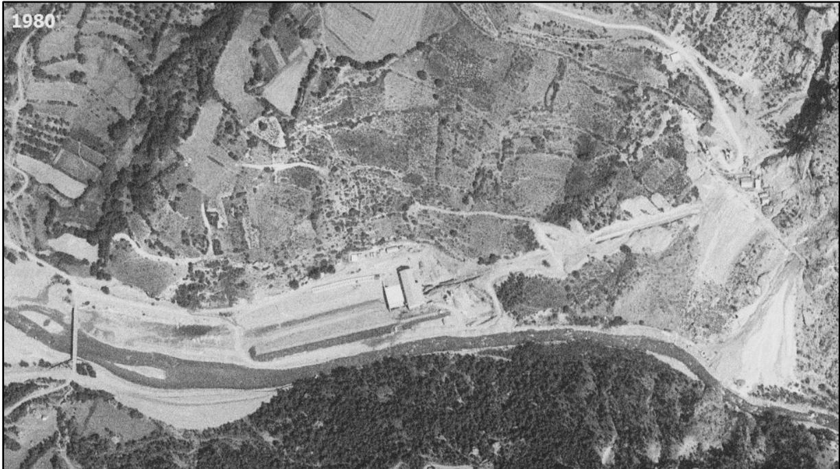
On repère déjà les surfaces construites de la centrale, le creusement du canal de sortie et l'accès latéral, l'axe de la conduite forcée, les braquements en haut et en bas, et tout ce qui a été extrait de la galerie en deux endroits. Le Guil a été-t-il repoussé vers la rive gauche ?
